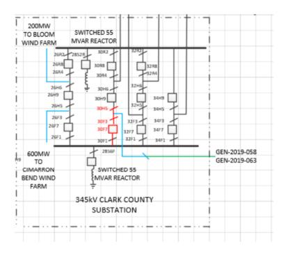
Figure 1 GEN-2019-058 AND 2019-063 Interconnection Substation One Line
